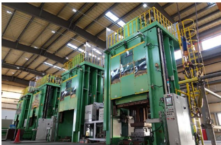
溶湯鍛造を支える高圧プレス機
