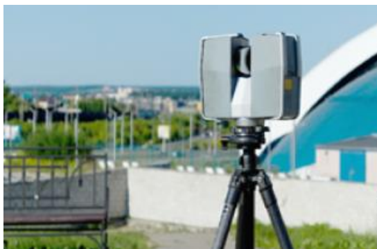
地上型及びドローン型の 3 次元測量機
