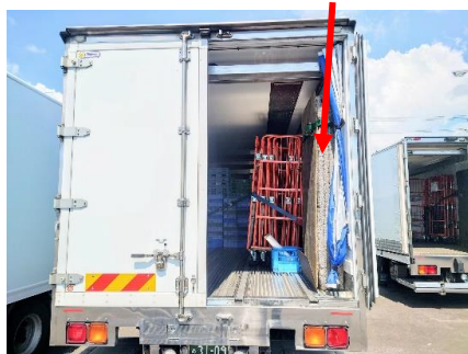
同社 4t 冷蔵冷凍車 荷物室間仕切
