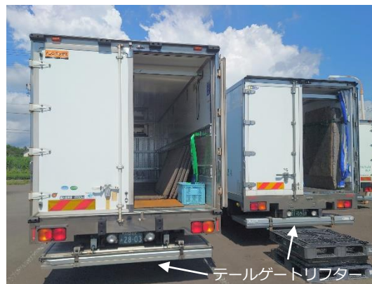
同社 4t 冷蔵冷凍車テールゲートリフター
