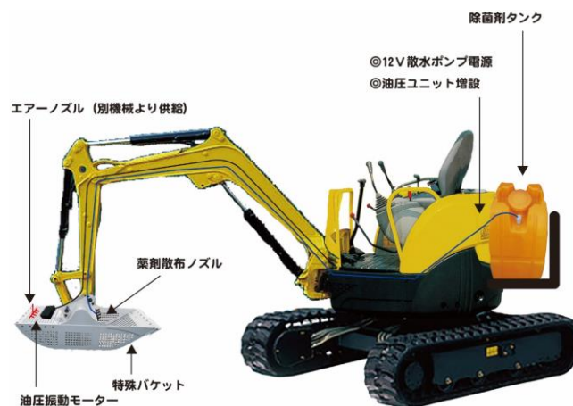
「ゴミ選別・抗菌剤散布機能つき油圧式ミニショベル」
