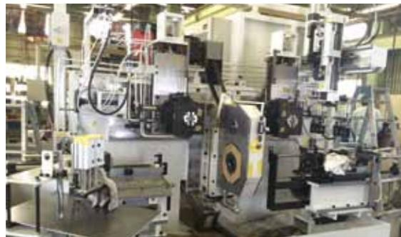
独創的な技術が継承されているワーク回転式両端同時加工機
