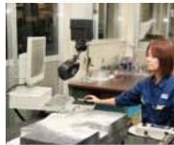
3Dカメラで型をスキャン・検査していく。国内でも数少ない装置。
