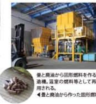
豊と廃油から固形燃料を作る製造機。温室の燃料等として再利用される。
