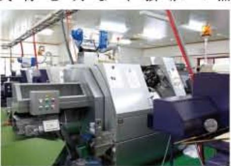
天城工場では、整形外科用補助器具、マイクロネジ・マイクロバーツなど高精度なチタン加工を行う。
